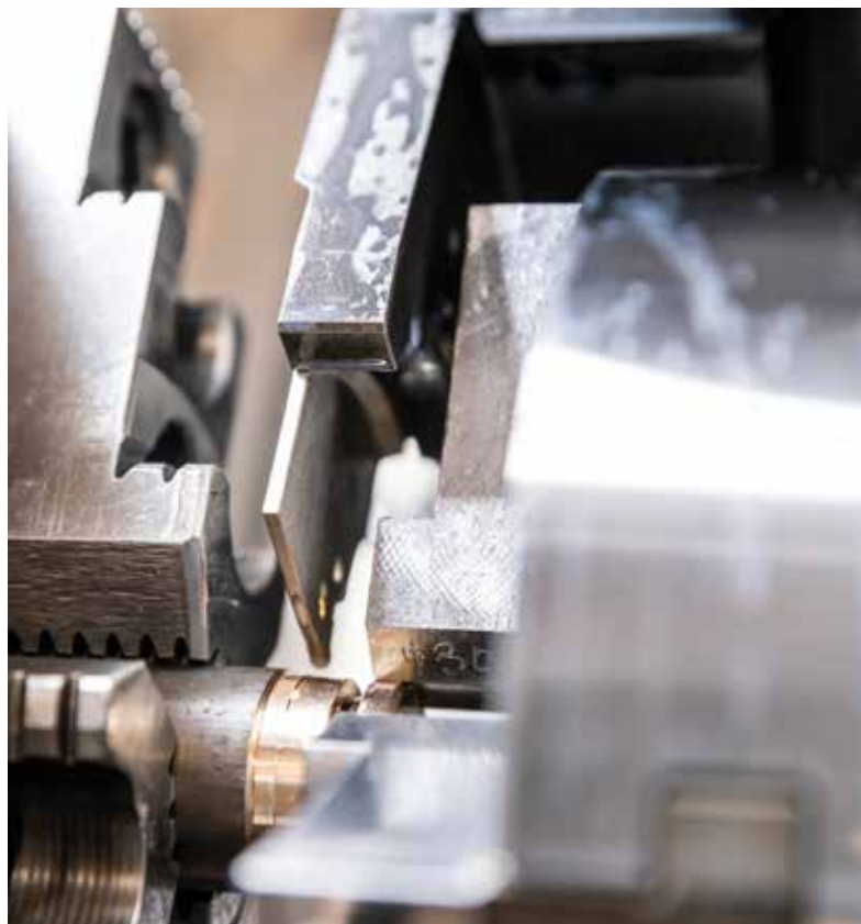
Avstickning med Modular Grip som ger möjlighet till mycket höga skär- och matningshastigheter.
