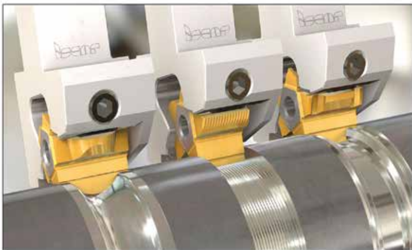
Bild 4 – PENTACUT-27 är ett stjärnformat ämne som gör det möjligt att skapa egna skär för komplex profilspårvarvning.
