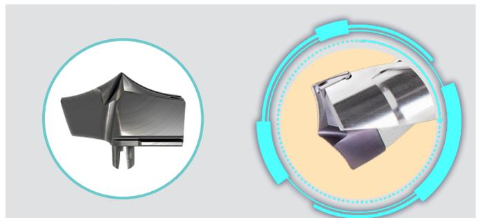
Familia CHAMIQDRILL para una gama de taladrado de 33 a 40 mm (1.3-1.574") con longitud de 1.5, 3, 5 y 8 veces el diámetro. Las herramientas CHAMIQDRILL tienen un diseño exclusivo que utiliza la flexibilidad del metal duro como autofijación, eliminando la necesidad de elementos de fijación. La robusta estructura de la broca con filos de corte cóncavos permite elevados índices de avance y proporcionando una tolerancia del agujero de gran precisión : IT8 - IT9
