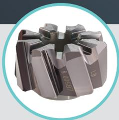
Cabezas de escariado intercambiables de metal duro integral a izquierdas con mecanismo de cambio rápido de tipo bayoneta para el escariado a alta velocidad de agujeros pasantes con tolerancia H7.
