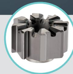
Cabezas de escariado intercambiables de metal duro integral de labios rectos a izquierdas con mecanismo de cambio rápido de tipo bayoneta para el escariado a alta velocidad de agujeros ciegos con tolerancia H7.
